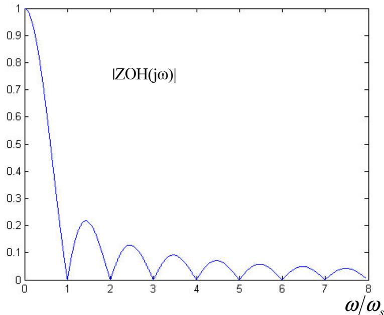
$$\begin{cases} \lim_{\omega \rightarrow 0} |ZOH(j\omega)| = 1 \\ |ZOH(j\omega)|_{\omega=k\omega_s} = 0, \quad k = 1, 2, \dots \end{cases}$$
